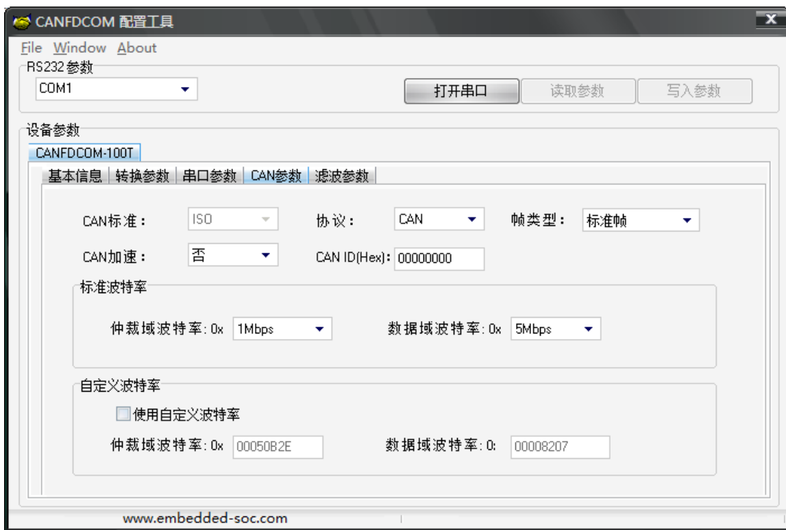
图3.3 CAN参数设置
