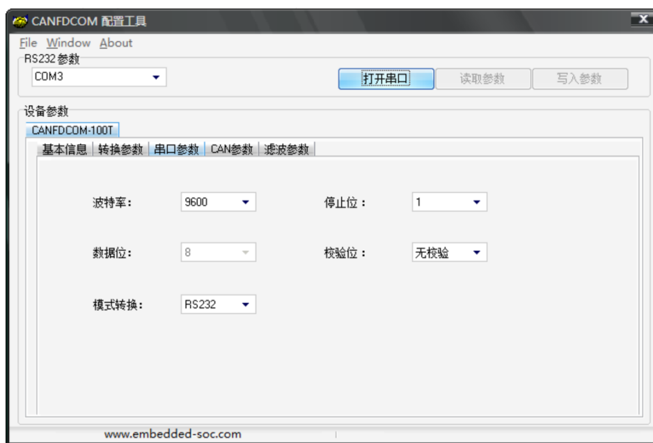
图3.2 串口参数设置
